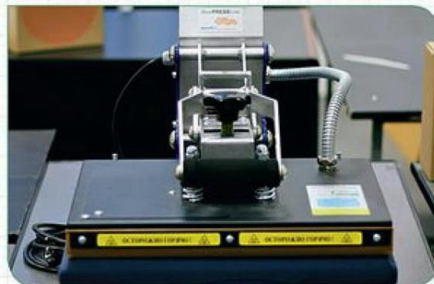
▲ Термопресс Shulze Blue-Press 1 (термоперенос на ткань)
