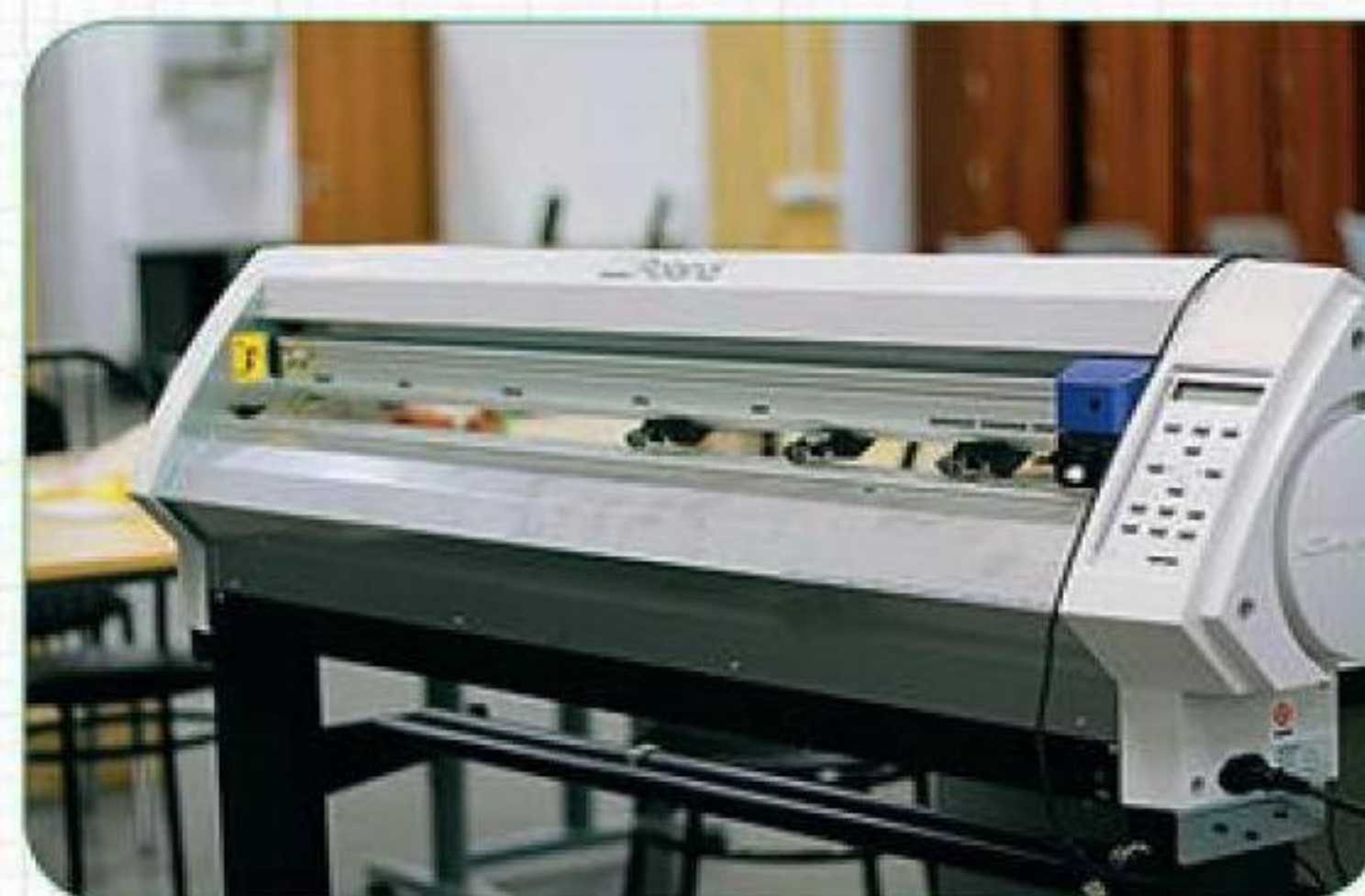
▲ Плоттер Roland GX-400 (резка винила, картона)
